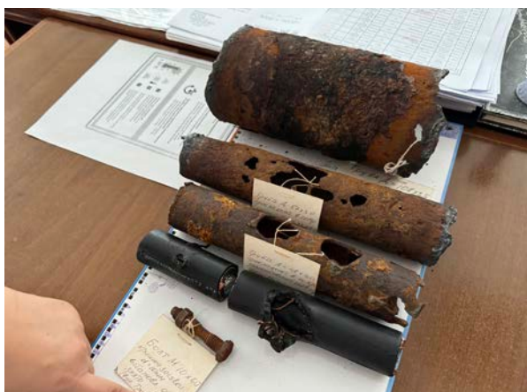
Figur 7: Eksempler på korrosion af rør i vand- og varmforsyningen
